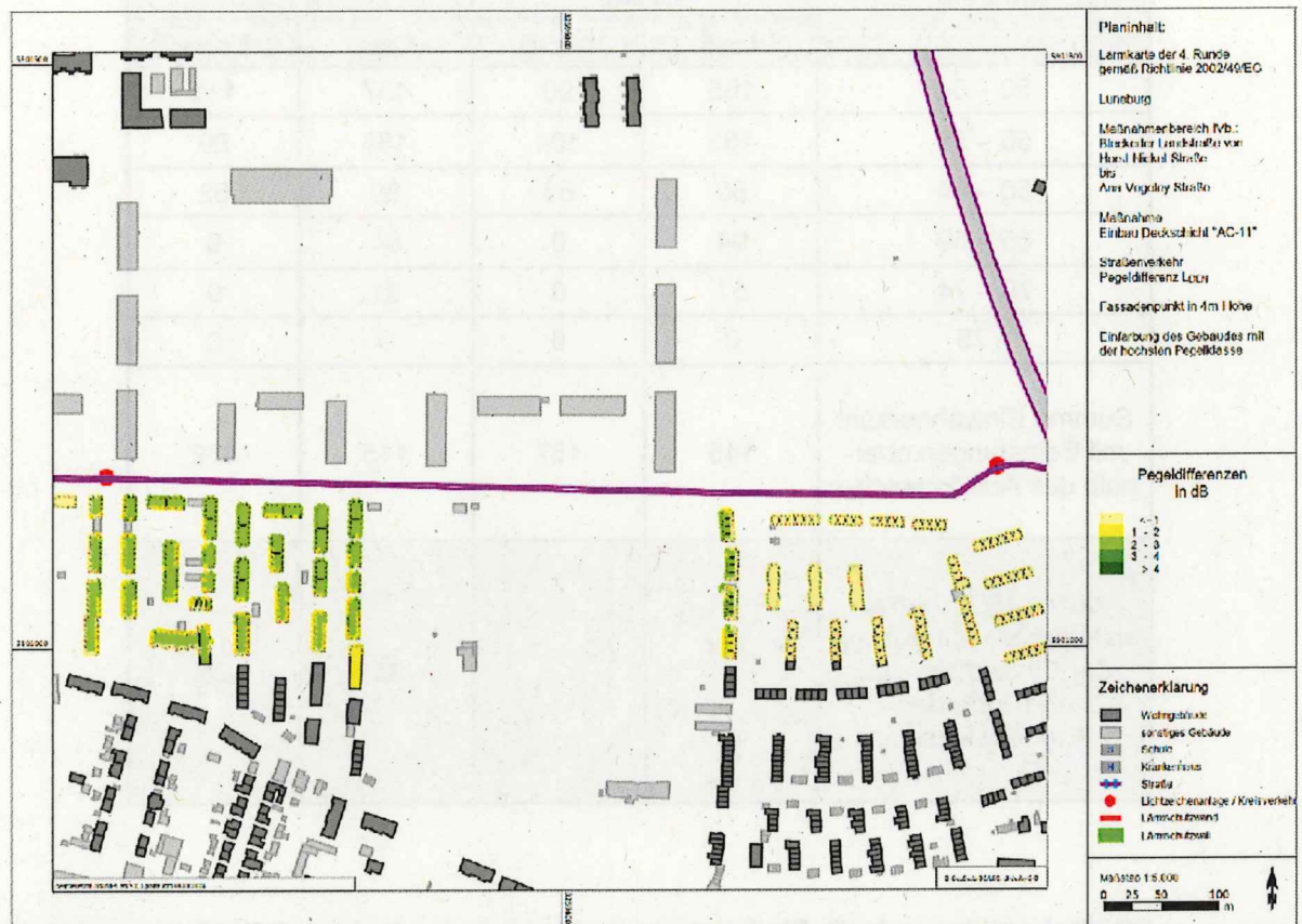
Abbildung 22: Differenzlärmmesskarte zur Maßnahme Deckensanierung im Maßnahmenbereich IV b
