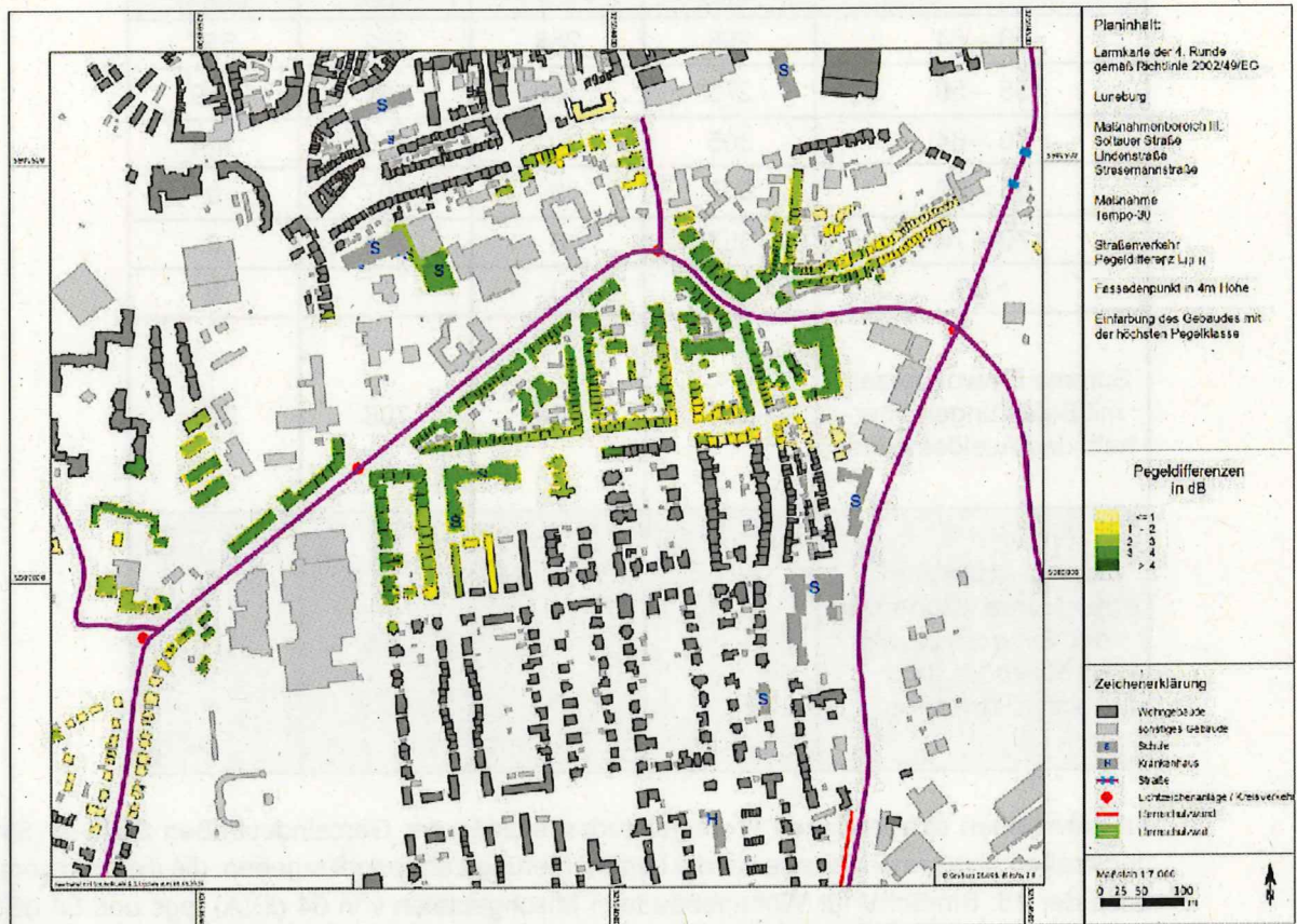
Abbildung 18: Differenzlärmappe zur Maßnahme Temporeduzierung im Maßnahmenbereich III
