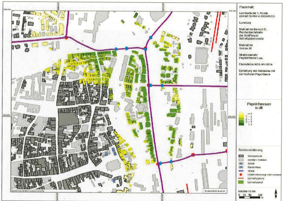
Abbildung 16: Differenzlärmkarte zur Maßnahme Temporeduzierung im Maßnahmenbereich II
