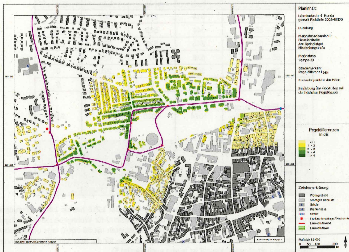
Abbildung 13: Differenzlärmappe zur Maßnahme Tempo 30 im Maßnahmenbereich I
