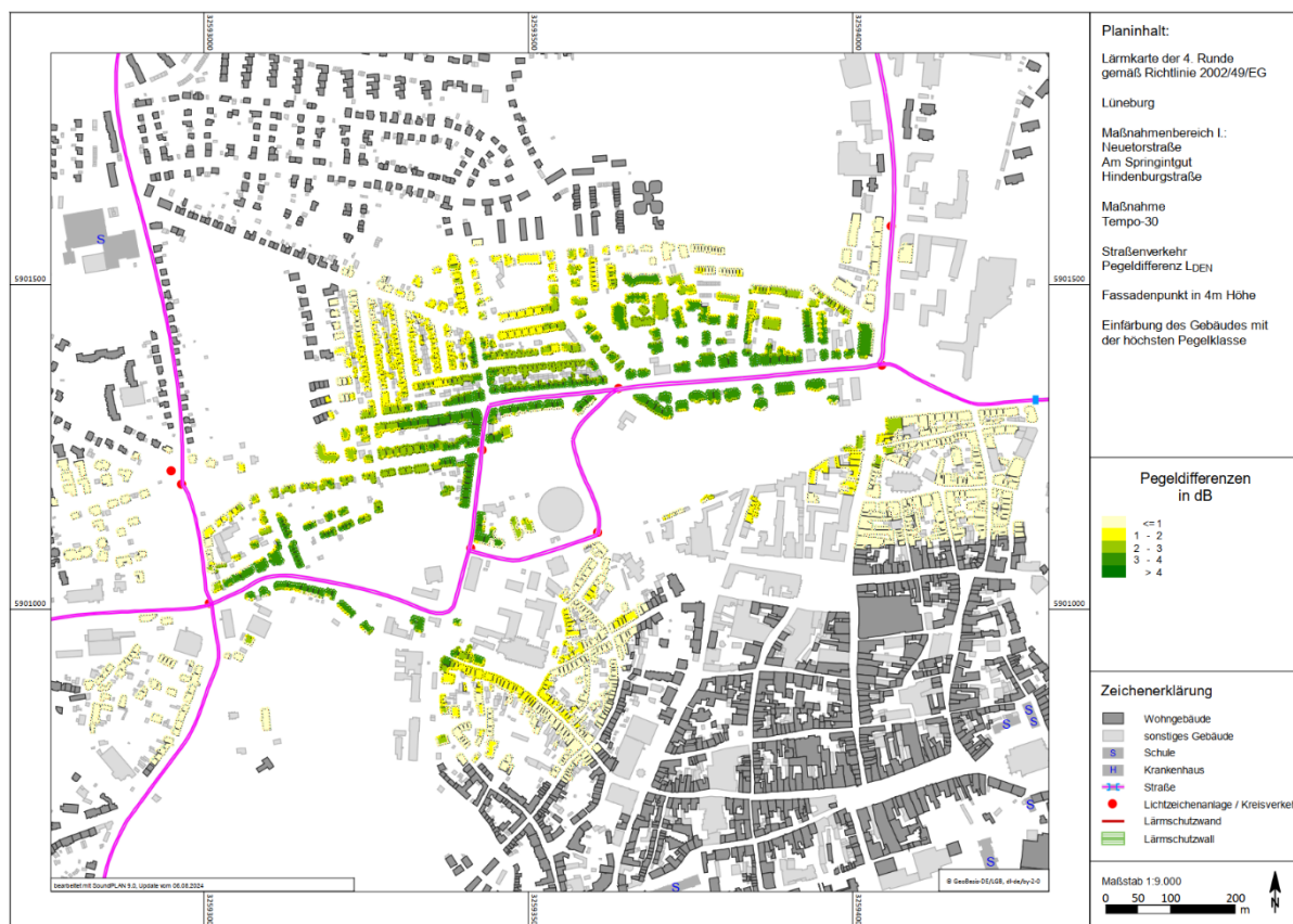
Abbildung 13: Differenzlärmkarte zur Maßnahme Tempo 30 im Maßnahmenbereich I
